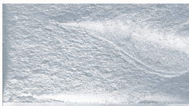
图5 裂纹断口形貌
