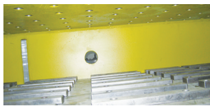
图2 工作台安装的气垫防磨板
