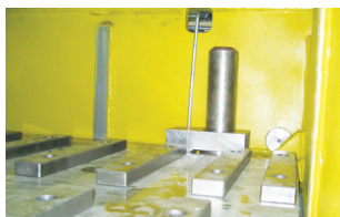
图3 安装在防磨板四角的提升缸
