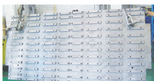
图1 安装在工作台内的气垫防磨板 (气垫模销提升板)
