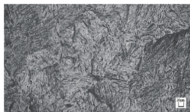
图2 860℃加热淬火显微组织
