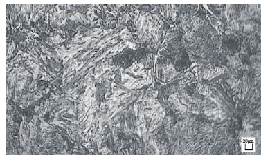
图3 880℃加热淬火显微组织
