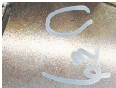
图5 加工麻点缺陷
