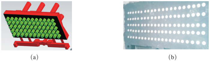
图11 直冷冷铁（钢制）工艺
