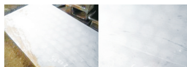
图6 加工后冷铁印记缺陷
