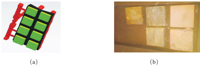
图12 隔砂冷铁工艺
