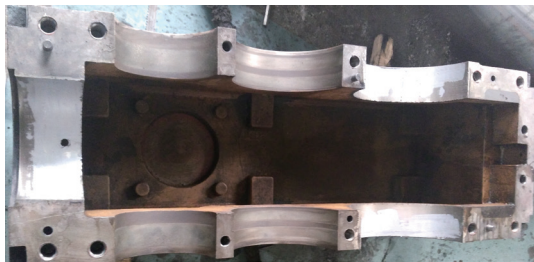
图2 修复后的M3RSF70型减速机箱体上半部分
