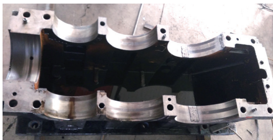
图1 焊补中的M3RSF70型减速机箱体下半部分
