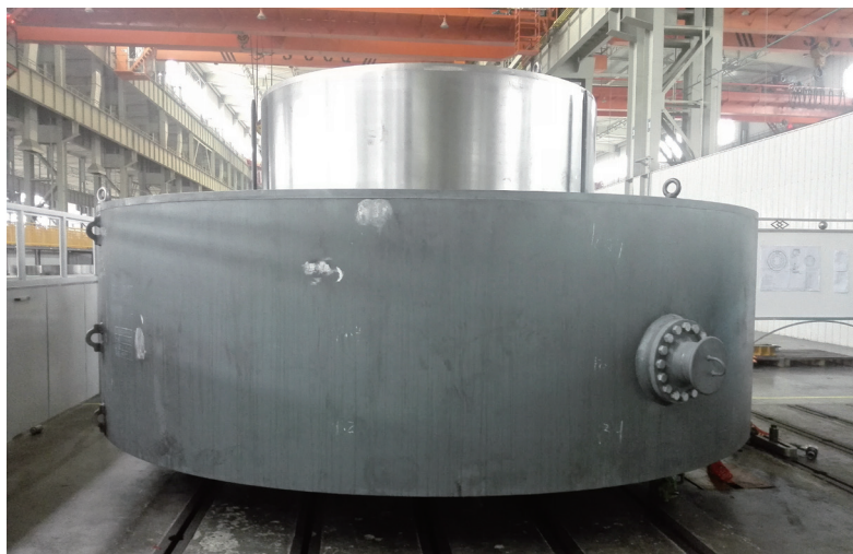
图9 2.5MW转子机座成品
