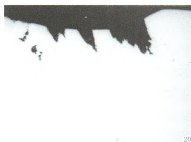
图6 钢球心部条带的剖面形貌
