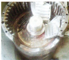
(a) 辊端轴套断裂后的形态
