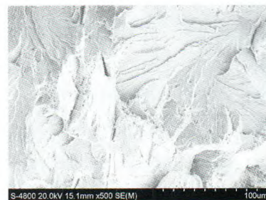
图5 裂纹断口形貌
