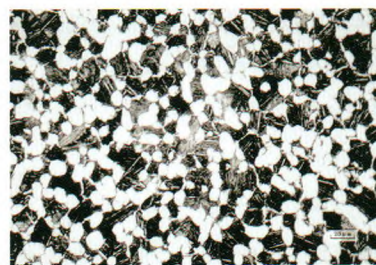
图1 中间饼坯锻造试验前的原始组织
