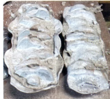
图10 实际生产中的压扁件、预锻件充满情况
