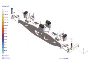
图12 凝固时间1000s时缩孔、缩松分布
