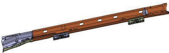
图1 门槛焊接总成
