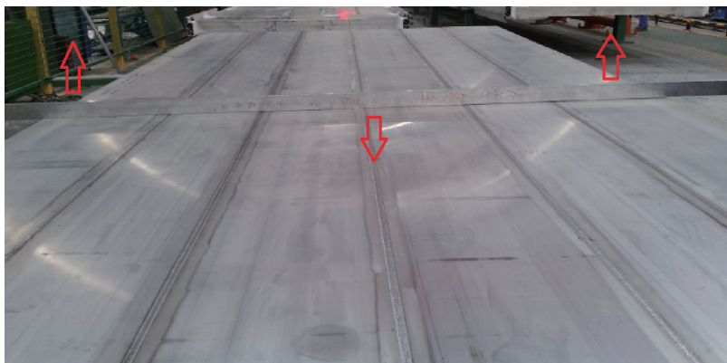
图4 长地板原焊接顺序
