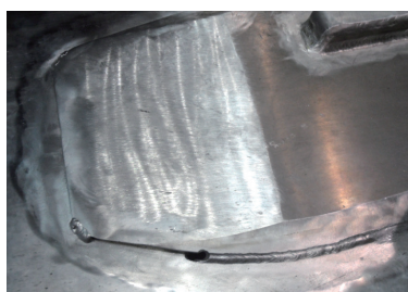
图4 由于变截面受热过大造成的焊穿缺陷
