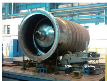
图7 电加热器套管孔加工
