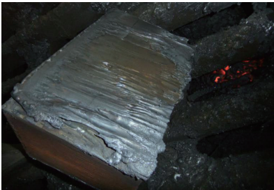
图3 乙炔气切割表面质量
