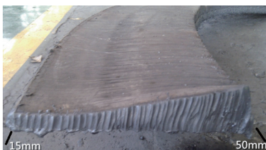
图5 丙烷气手工切割效果
