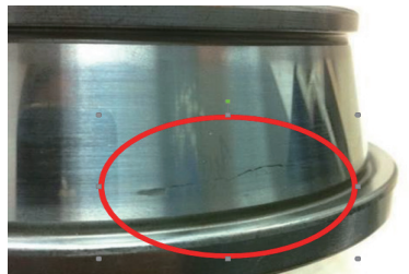
图9 内圈外外滚到折叠裂纹
