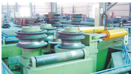
图10 圆管冷弯（滚弯工艺）
