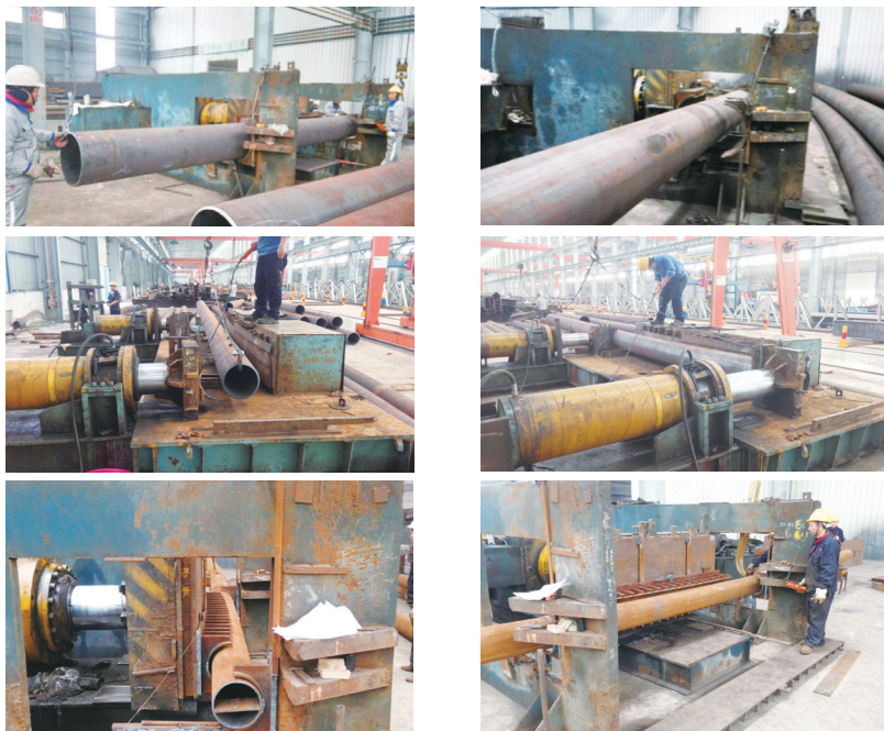
(a) 直口圆管冷弯（顶弯工艺）
