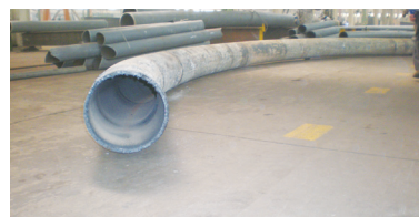
(b) 直口圆管热弯成形(中频感应及高频感应弯制)
