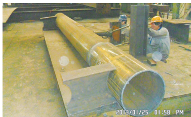
(a) 直口圆管热弯成形(火工热弯)
