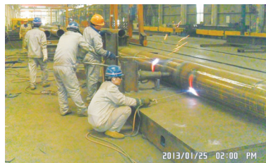
(a) 直口圆管热弯成形(火工热弯)
