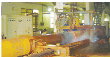
(b) 直口圆管热弯成形(中频感应及高频感应弯制)
