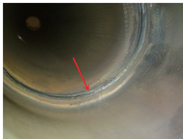
图4 打底根部未熔合
