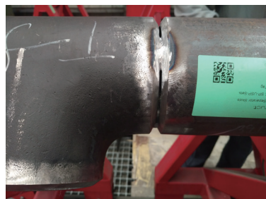
图1 良好的焊前装配点焊
