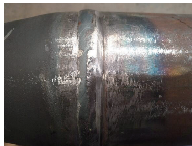
图6 表面未熔合的修复焊前
