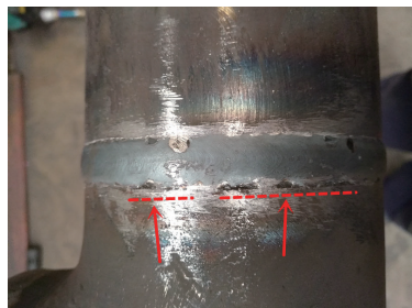
图3 表面坡口的未熔合
