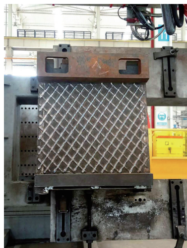
图3 机器人焊后的耐磨层
