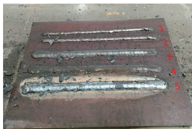
图1 5种参数下对应的焊缝
