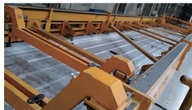
图3 底架组焊工装
