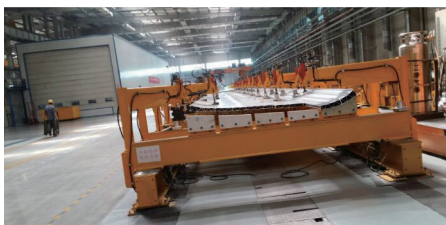
图4 侧墙组焊工装
