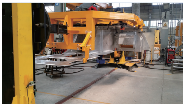
图2 牵缓组成组焊工装
