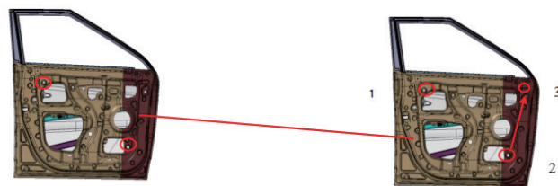
图3 车门内板定位结构
