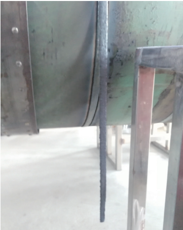
图3 焊缝脱渣现场
