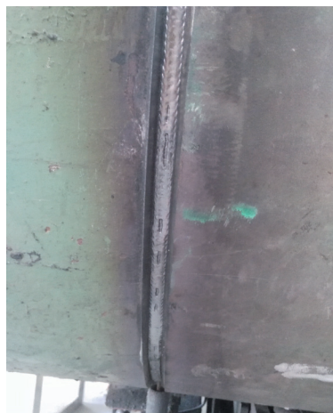
图2 成形优良焊缝
