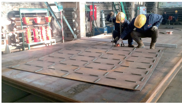
图2 焊完防滑条的上面板
