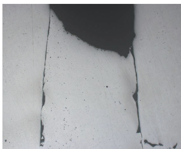
图8 未腐蚀 焊接裂纹 50×
