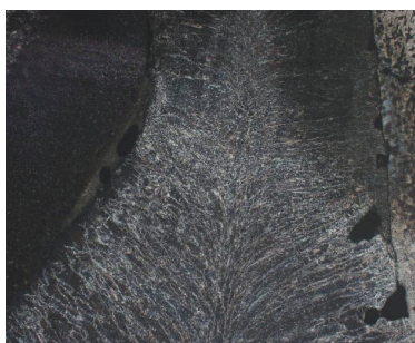
图9 腐蚀后 焊接裂纹 50×
