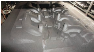
图7 管身各处均没有加冒口补缩
