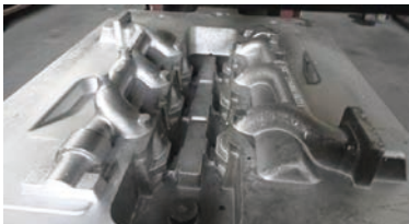
图7 管身各处均没有加冒口补缩
