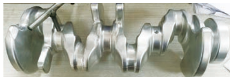
图10 用于凹模刃口检查的铝制样件
