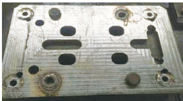
图9 切边凹模加工胎具
