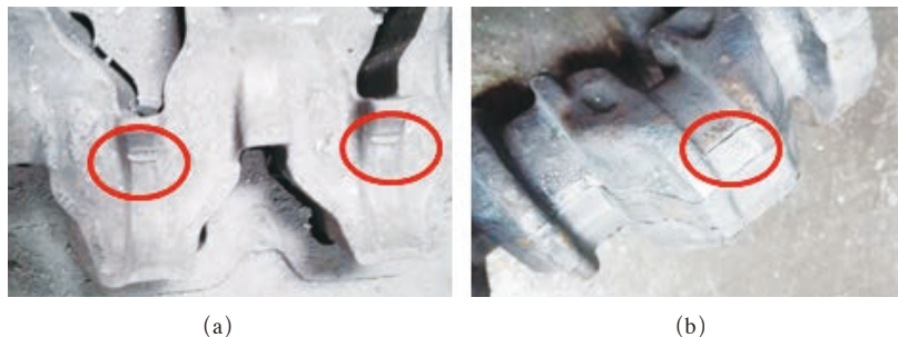
图3 上下冲头空车撞击导致的模具压堆及锻件压印
