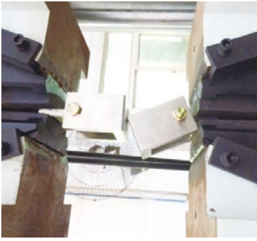
图6 抽芯铆钉拉力试验
