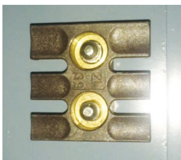
(b) 扎线排采用环槽铆钉铆接
