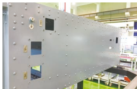
(c) 矩形插头安装用六角铆螺母铆接
