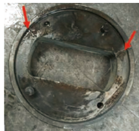
图3 1 # 模具导向开裂图 (图中箭头为开裂部位)
