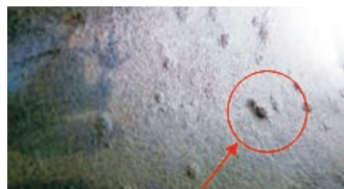
图1 STR缸套内孔出现的浮渣
