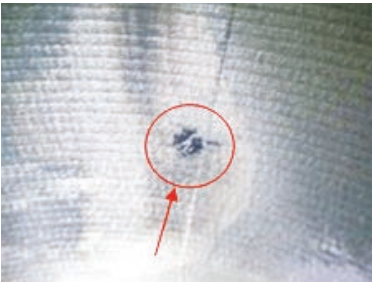
图3 STR缸套粗铰后内砂气孔
