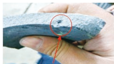
图2 与浮渣对应的气孔
