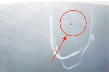
图4 STR缸套精磨后内砂气孔
