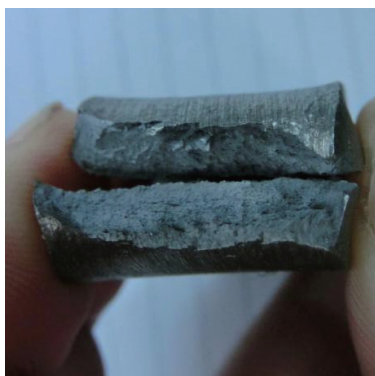
图3 晶间腐蚀弯曲断面形貌
