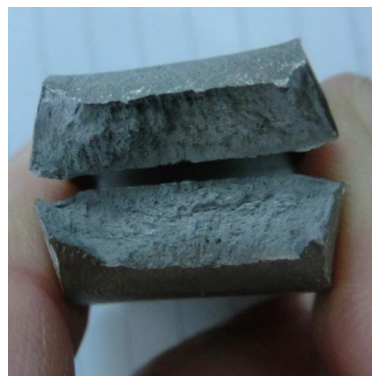
图3 晶间腐蚀弯曲断面形貌
