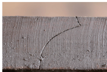
图2 底板侧面裂纹发展方向
