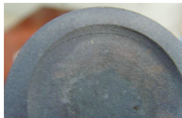
图2 气门底窝裂纹
