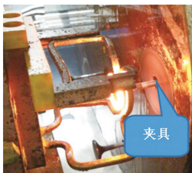
图10 加热的气门与夹持的夹具
