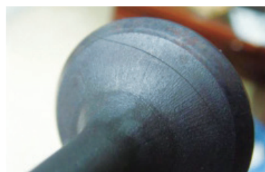
图3 气门圆弧与锥面裂纹
