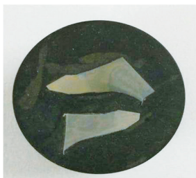
图8 锥面淬火裂纹(上)与无裂纹(下)的硬化层深度对比
