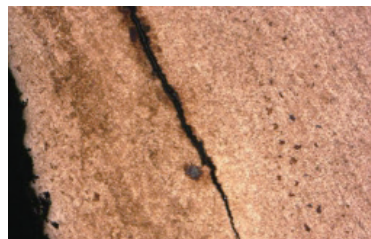
图4 气门盘部淬火裂纹
