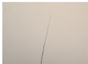
图7 轮齿端面裂纹深度形貌
