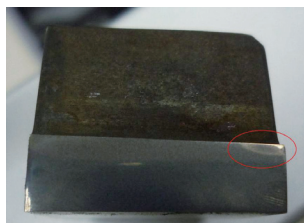
图6 沿齿根纵向切面淬硬层
