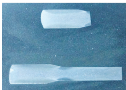
图10 某型变档拨叉改善后硬化层示意
