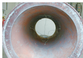
图4 内部的热电偶位置
