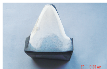
图7 从动齿轮淬硬层深度及完整性检验结果
