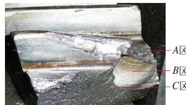
图3 从动齿轮疲劳断裂断口
