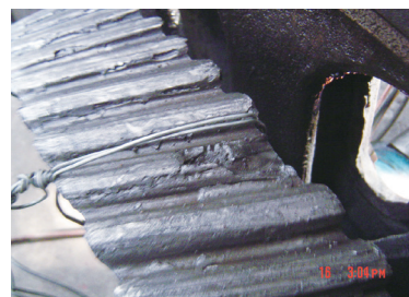
图2 轮齿在中部偏向车轮部位发生疲劳裂纹
