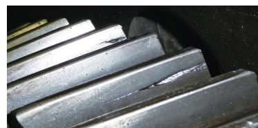
图1 轮齿靠车轮的一侧出现的裂纹
