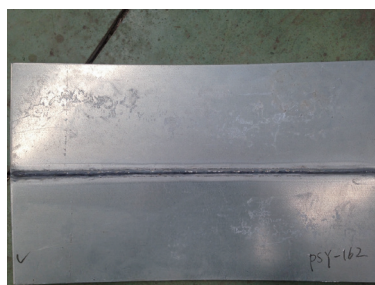
图6 焊接背面成形
