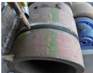
图1 埋弧焊防焊剂脱落装置
