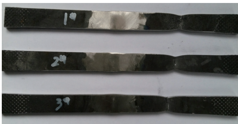
图6 拉伸试验结果
