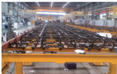
图6 骨架组焊工装
