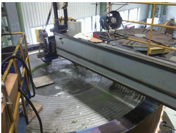
图6 产品埋弧带极自动堆焊照片
