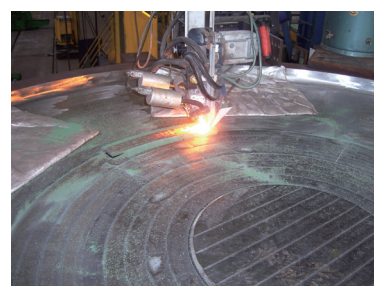
图8 产品电渣带极自动堆焊照片
