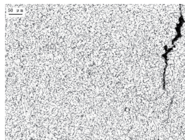
图10 中间壁厚处热影响区的裂纹
