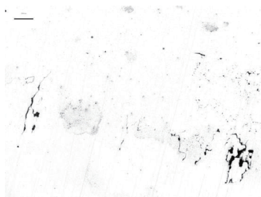
图12 2#管泄漏处内部裂纹形貌
