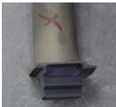
(a) 改进方案1叶片加热氧化后效果
