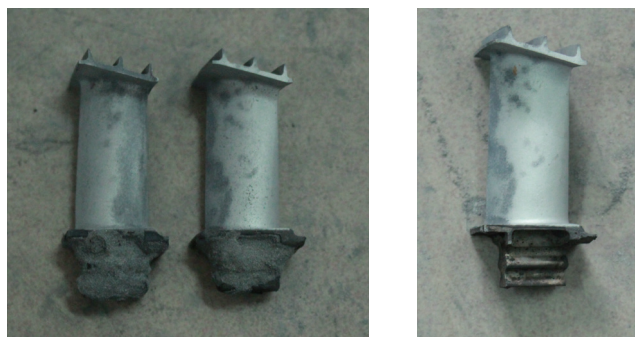
(a) 改进方案1叶片渗铝后防护层效果 (b) 防护层去除后榫头表面
