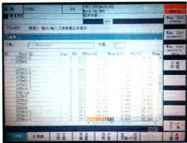
图12 安装新刀盘并自动读取新刀具数据
