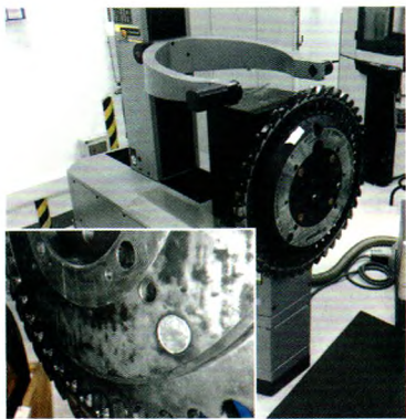
图10 线下刀盘位置数据测量机和刀具数据存储芯片
