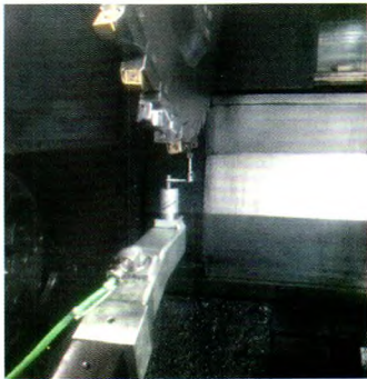
图9 使用机内对刀仪进行接触式测量对刀
