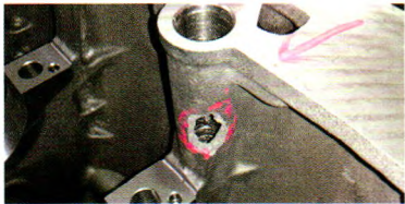
图3 断刀导致孔壁穿透
