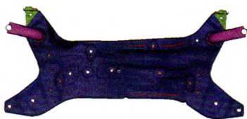
图2 前副车架有限元模型
