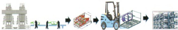
图7 冲压线线末叉车下料方式
