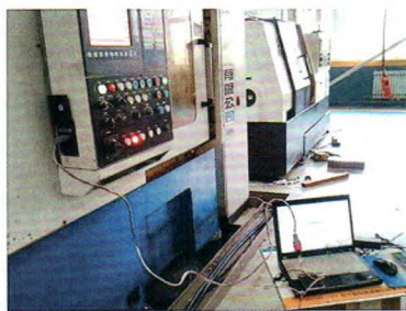
图4 外设PC与滚齿机802Dsl系统PCU的连接
